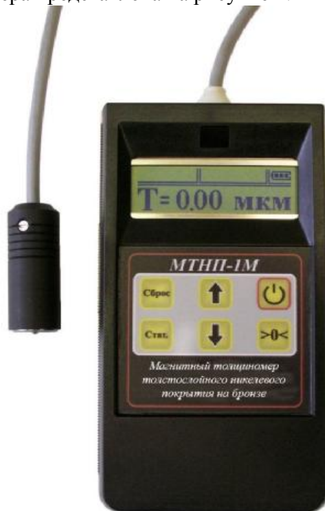
Рисунок 1 - Общий вид толщиномера магнитного толстослойного никелевого покрытия на бронзе МТНП-1М
