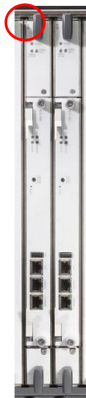
Фото 2 – Карты коммутации и управления (выделено место блокировки)
