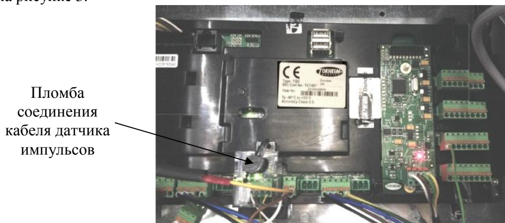
Рисунок 3 - Пломбирование платы электронно-вычислительного устройства ТЭС
