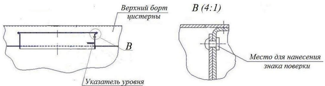
Рисунок 3 – Схема пломбировки от несанкционированного изменения положения указателя уровня налива в горловине цистерны, обозначение места нанесения знака поверки
