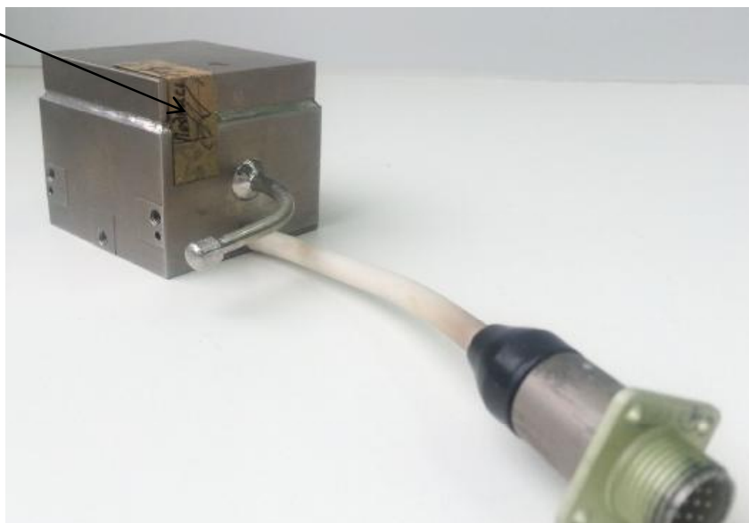
Рисунок 3 – Место нанесения защитной наклейки от несанкционированного доступа
