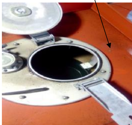
Рисунок 1- Обозначение места для нанесения знака поверки
