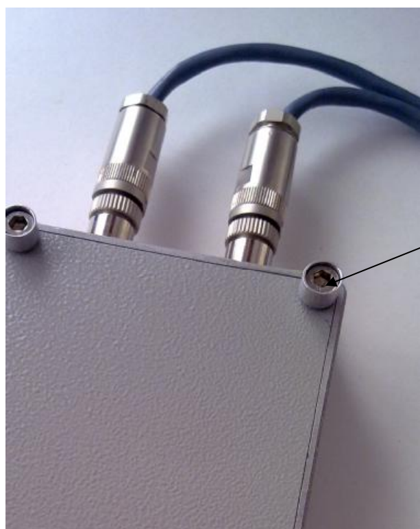
Рисунок 3 - Вид отсека печатной платы измерителей сопротивления изоляции МИС30 с указанием места установки мастичной пломбы
