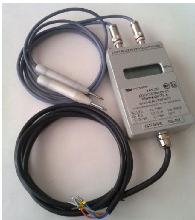
Рисунок 2 - Общий вид измерителя сопротивления изоляции МИС30 исполнения 000-018.0380-00-01
