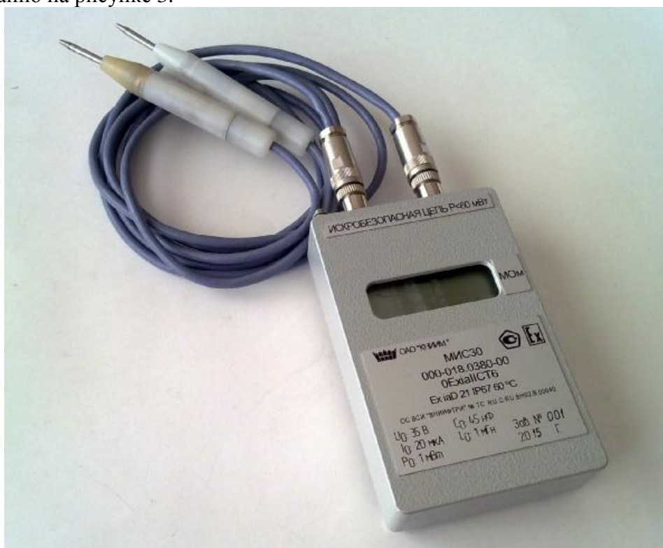
Рисунок 1 - Общий вид измерителя сопротивления изоляции МИС30 исполнения 000-018.0380-00
