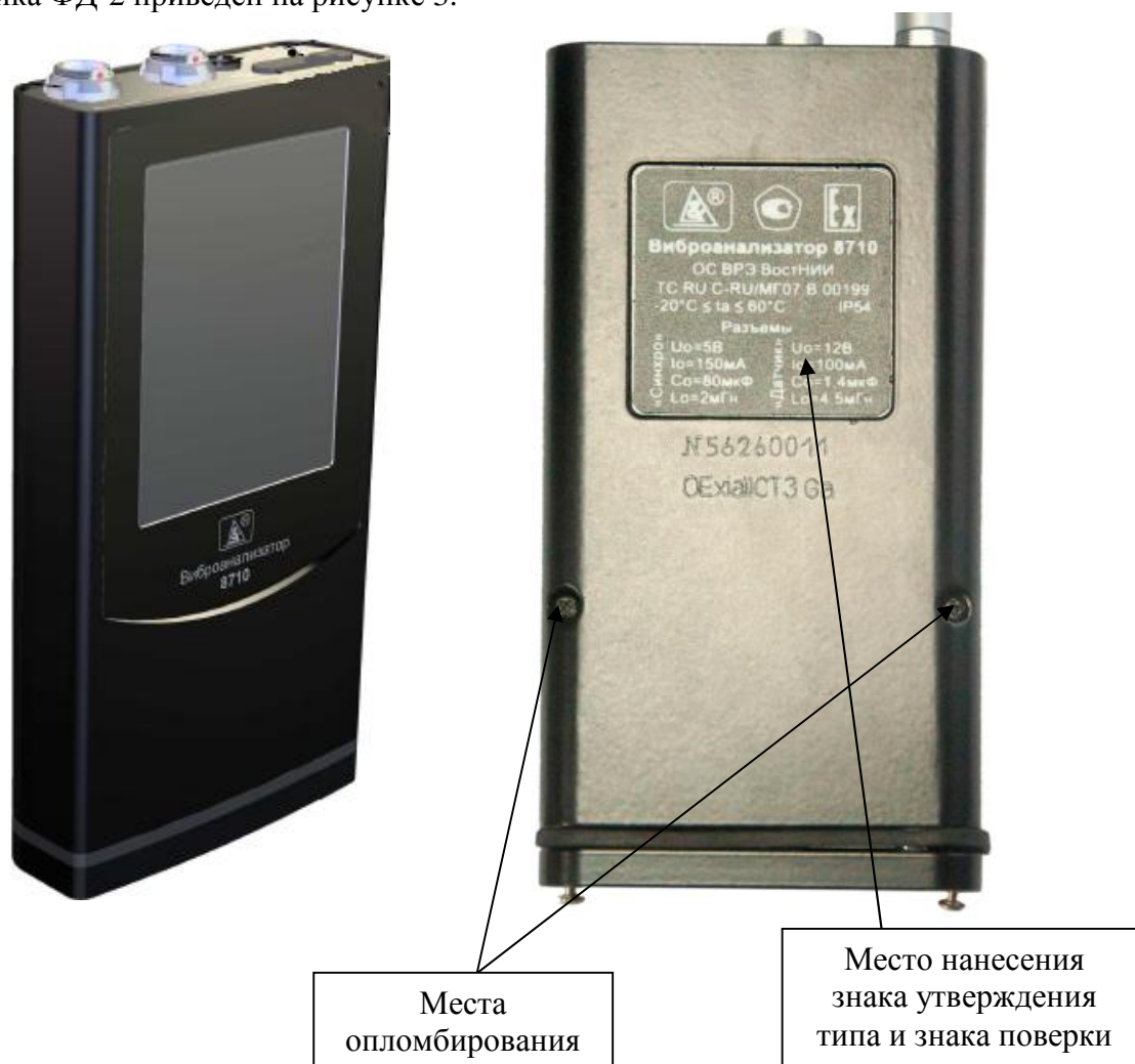
Рисунок 1 - Внешний вид вибронализатора 8710
