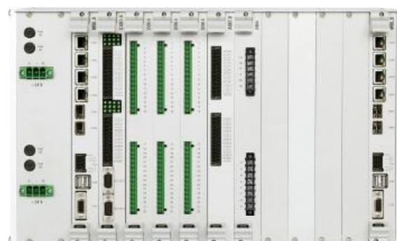
Рисунок 8 - Общий вид контроллера ARIS C306, вид сзади
