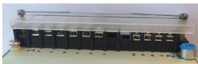
Рисунок 9 - Пломбировка клеммных соединителей измерительных цепей
