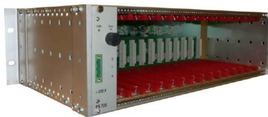
Рисунок 2 - Общий вид контроллера ARIS C303, вид сзади (модули не установлены)
