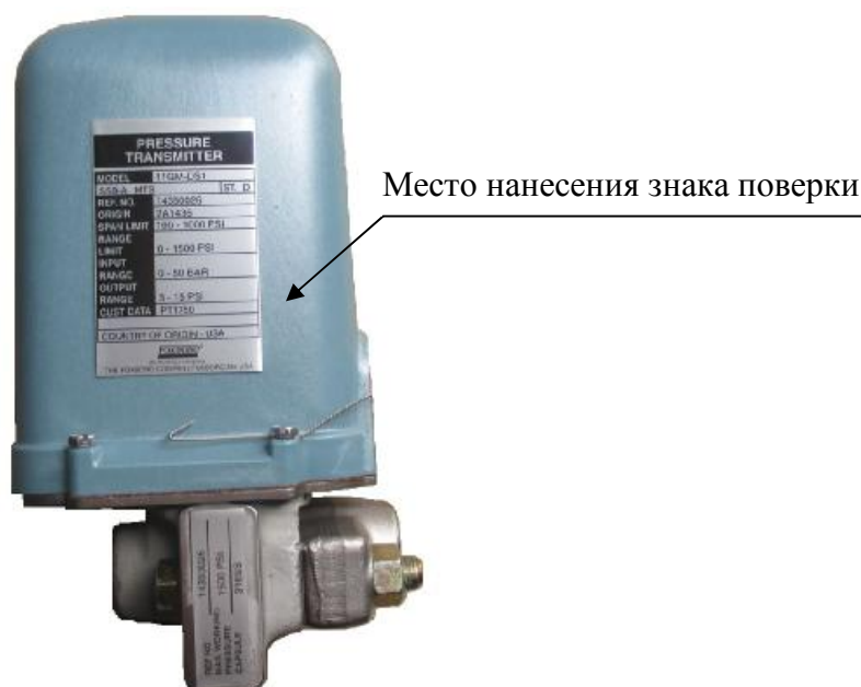
Рисунок 1 - Общий вид преобразователя давления измерительного пневматического 11GM с указанием места нанесения знака поверки
