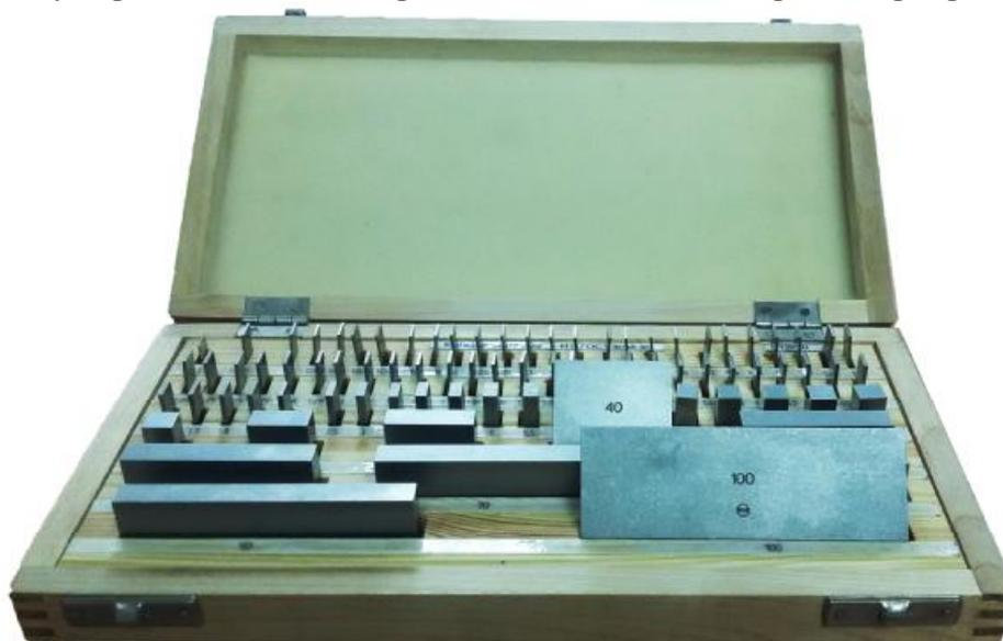
Рисунок 1 - Общий вид набора мер длины концевых плоскопараллельных
