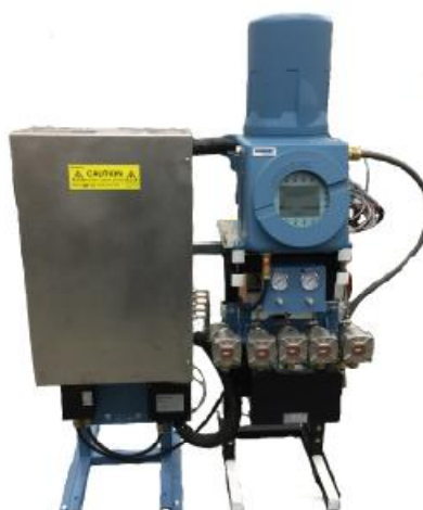
Рисунок 2 - Внешний вид комплекса хроматографического на базе хроматографов газовых промышленных модели 700XA для автоматического определения состава газа горючего природного и попутного нефтяного газа и продуктов его переработки с системой пробоподготовки
