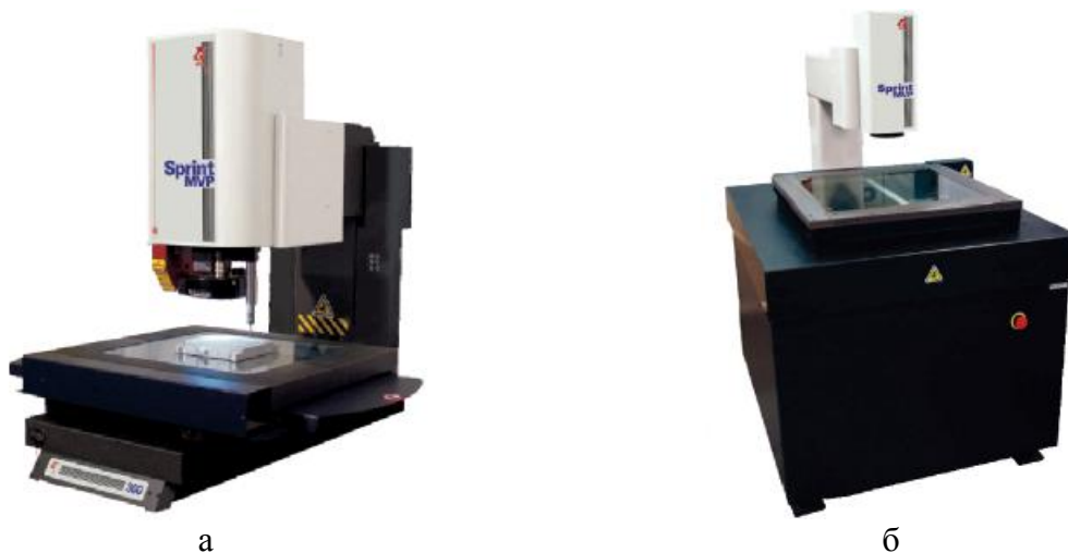
Рисунок 2 - Системы видео измерительные: а) Sprint MVP 200/250/300; б) Sprint MVP 400/600
