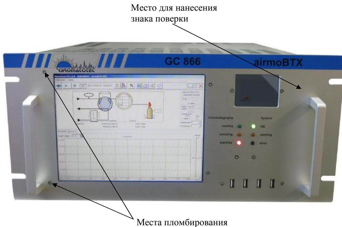
Рисунок 1 – Внешний вид аналитического блока airmo BTX Chromatotec GC
