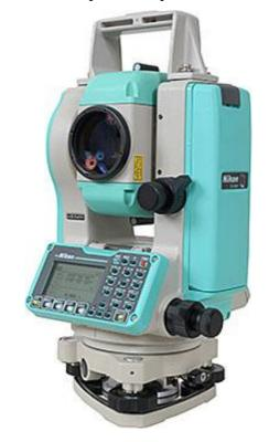
Общий вид тахеометров электронных Nikon NPL-322+
