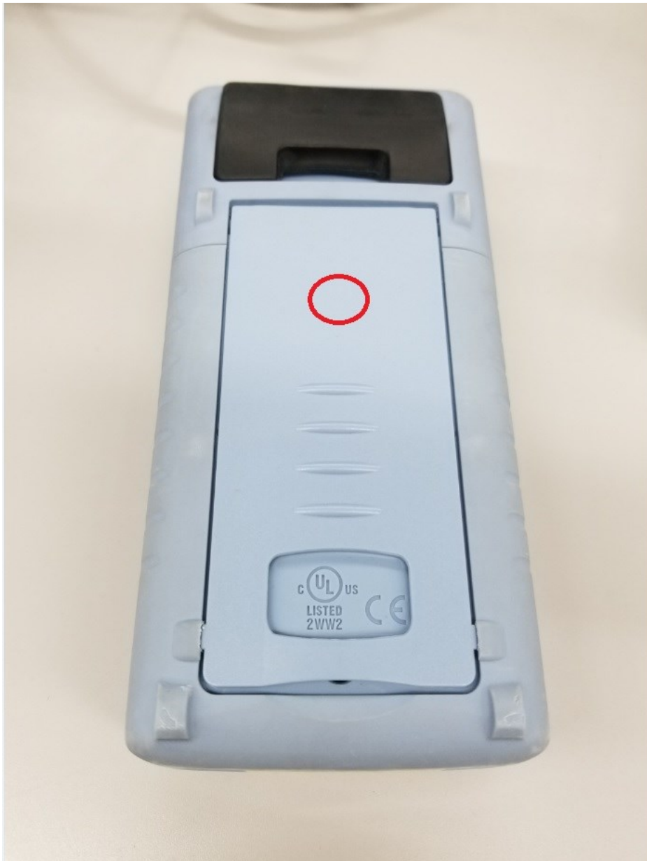
Рисунок 5 – Место пломбирования мультиметров от несанкционированного доступа
