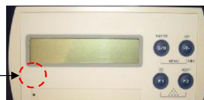
Пломбировка доступа к переключателю режимов настройки и юстировки на передней панели корпуса приборов модификаций WE2107, WE2108
