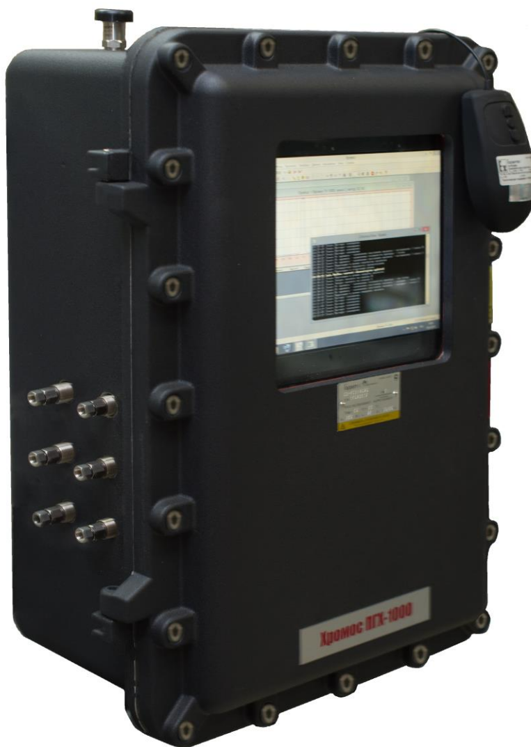
Рисунок 1 – Общий вид хроматографа газопромышленного специализированного «Хромос ПГХ-1000».
