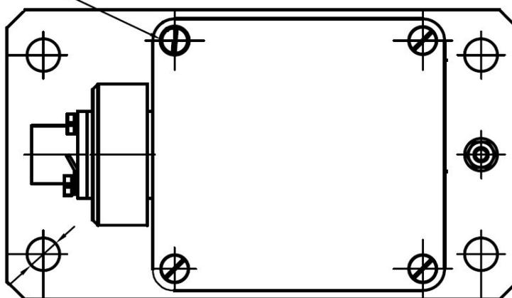
Рисунок 2 – Схема пломбировки от несанкционированного доступа и обозначение места нанесения знака поверки
