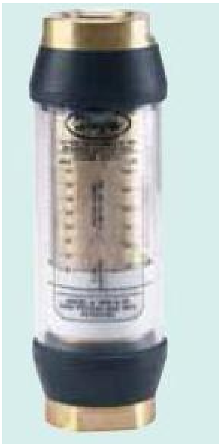
Рисунок 1 – Общий вид (фото) ротаметра НФВ-5-100
