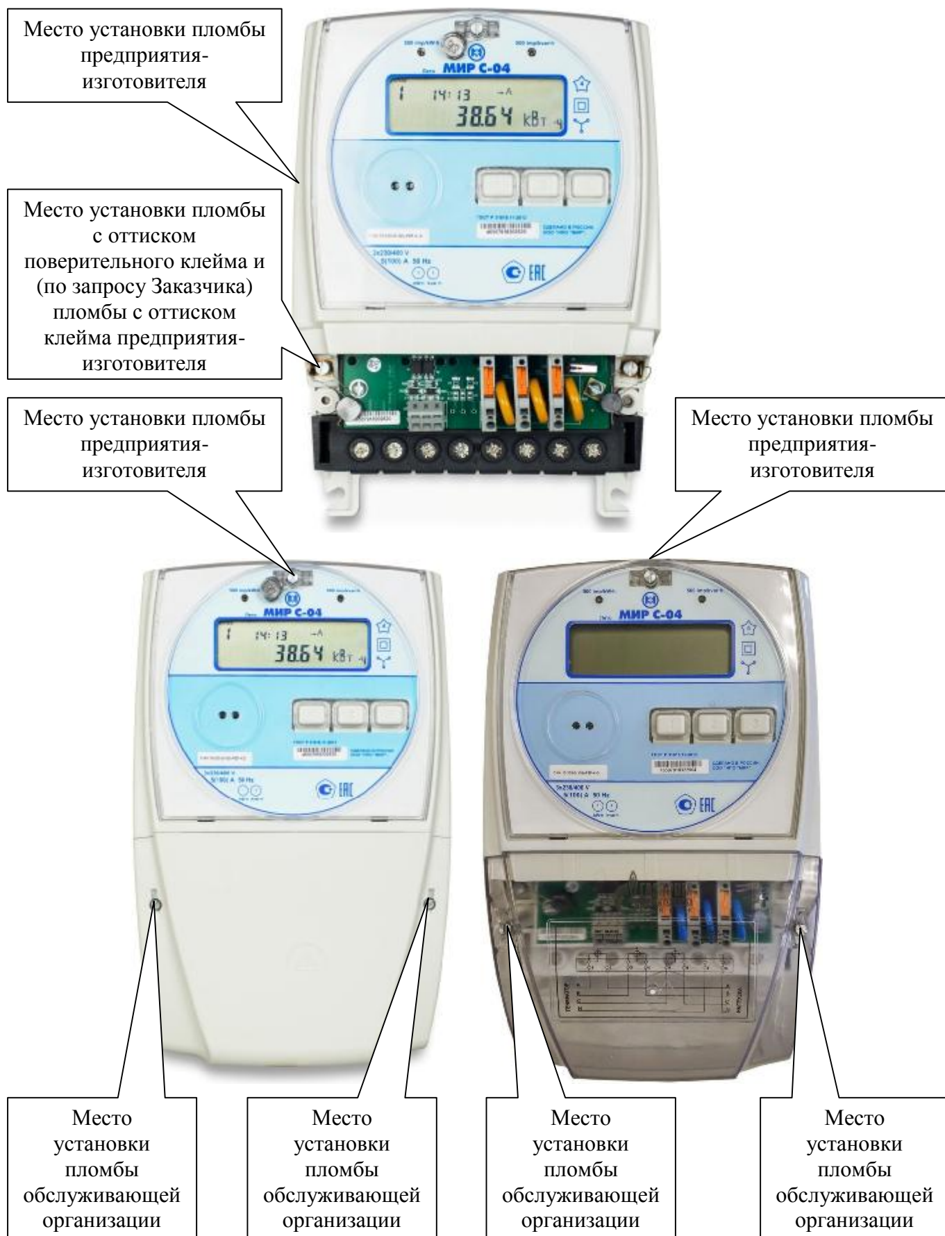
Рисунок 4 – Общий вид счетчиков МИР С-04 и схемы пломбировки от несанкционированного доступа, обозначения мест нанесения знака поверки
