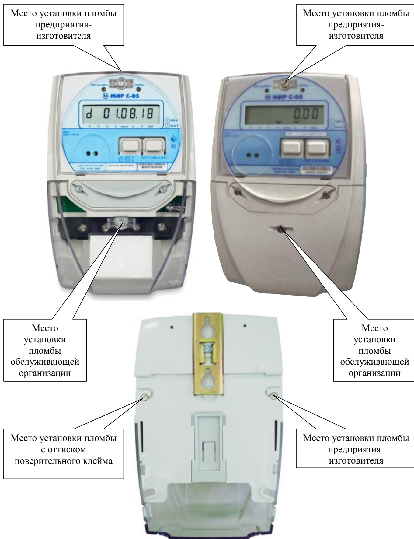
Рисунок 5 – Общий вид счетчиков МИР С-05, применяемых внутри помещений, и схемы пломбировки от несанкционированного доступа, обозначения мест нанесения знака поверки
