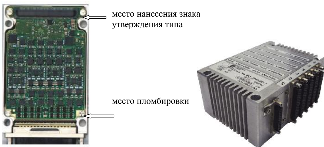
Рисунок 1 - Внешний вид модуля UMA 2015 и модуля UMA 2015, установленного в блок базовый UMA07B
