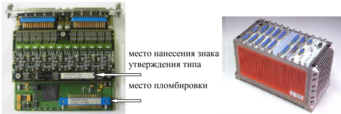
Рисунок 1 - Внешний вид модуля UMA 2015 и модуля UMA 2015, установленного в блок базовый UMA07B
