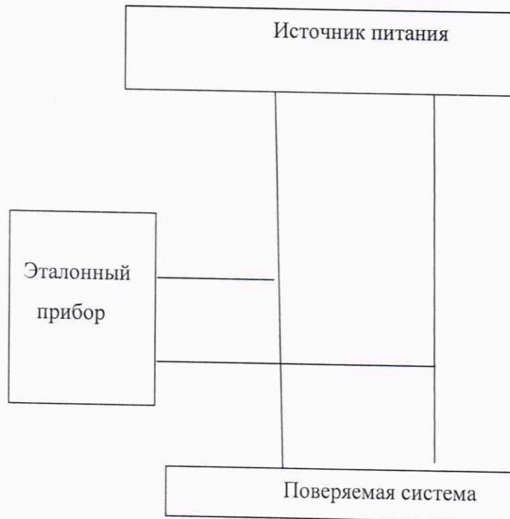
Рисунок 4 - Структурная схема для проверки допускаемой относительной погрешности измерений напряжения постоянного тока
