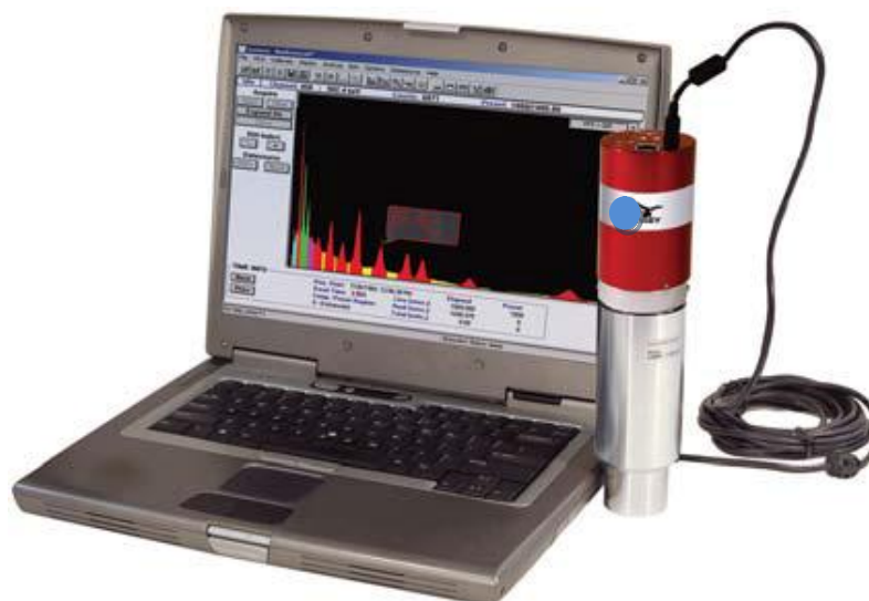
Рис. 1 Внешний вид спектрометров OSPREY-NS (Синей точкой обозначено место пломбирования от несанкционированного доступа).
