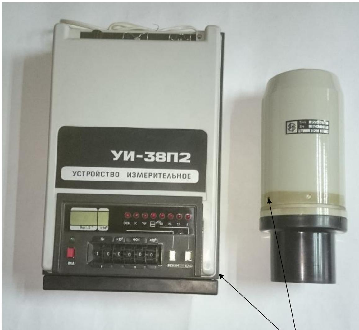
1 – Места пломбирования поверителем
