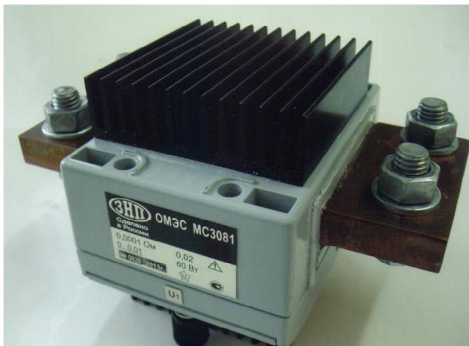
Рисунок 1 Мера электрического сопротивления однозначная МС 3081
