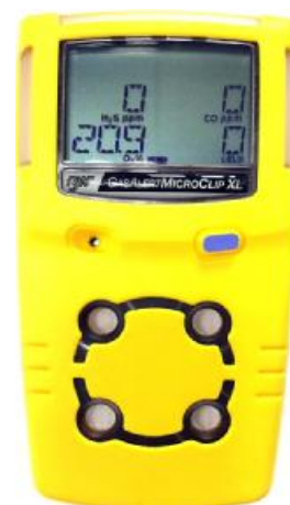
Рис. 6. Общий вид газоанализаторов BW модели GasAlertMicroClip XL
