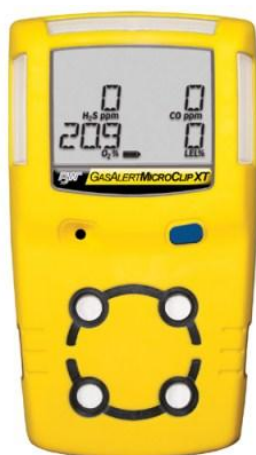
Рис. 5. Общий вид газоанализаторов BW модели GasAlertMicroClip XT
