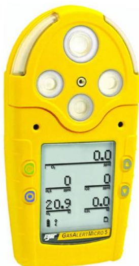
Рис. 9. Общий вид газоанализаторов BW модели GasAlertMicro5
