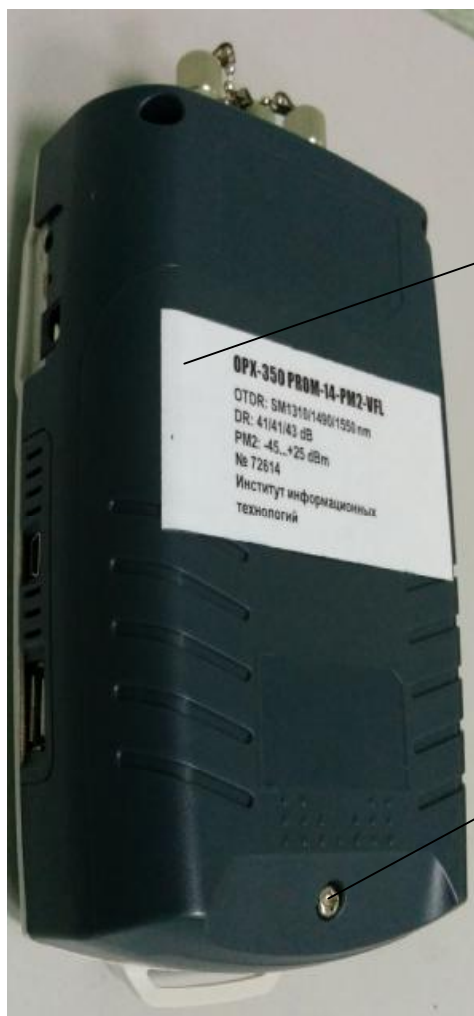
Рисунок 2 – Задняя панель приборов оптических измерительных многофункциональных OPX-350
