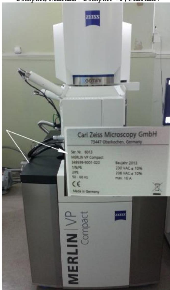
Рисунок 2 – Места нанесения маркировки на микроскоп.
