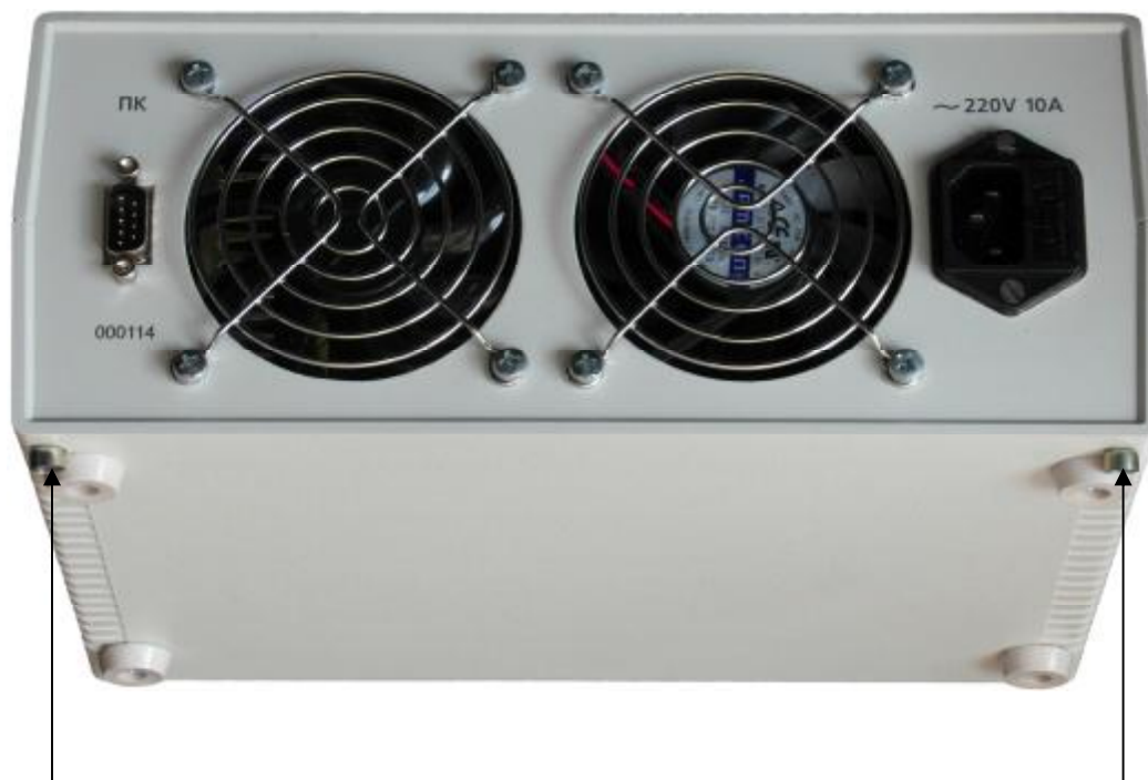
Рисунок 2 - Места нанесения поверительного клейма
