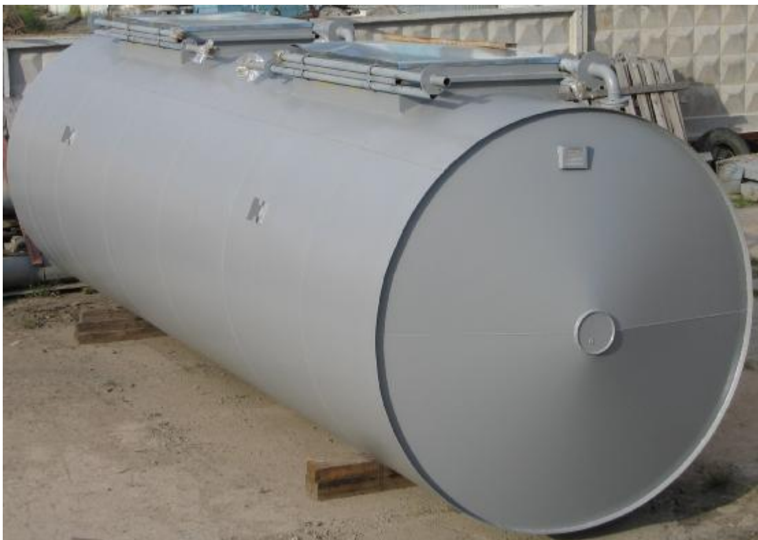
Фото 1. Общий вид резервуара РГСД 50/2 - П.
