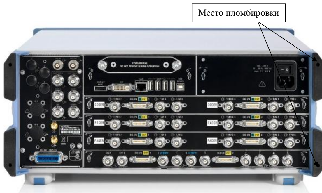
Рисунок 2 – схема пломбировки от несанкционированного доступа
