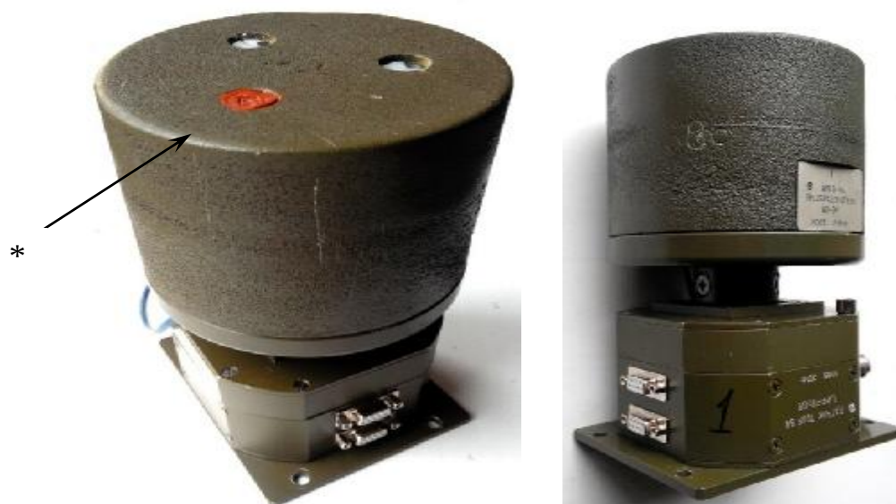
Рисунок 2 - Внешний вид датчика поля ВЧ цифрового * - место пломбировки от несанкционированного доступа
