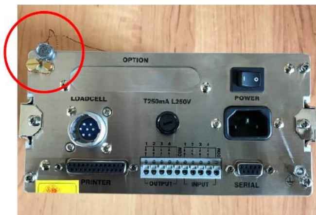
Рисунок 2 – Схема пломбировки CI-5010A от несанкционированного доступа
