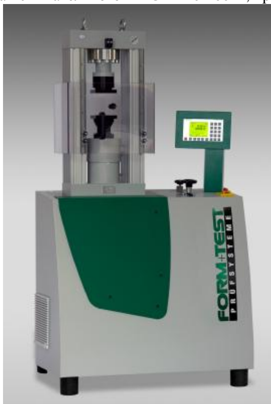
Рис. 1 - Внешний вид пресса испытательного MEGA 110-200 D
