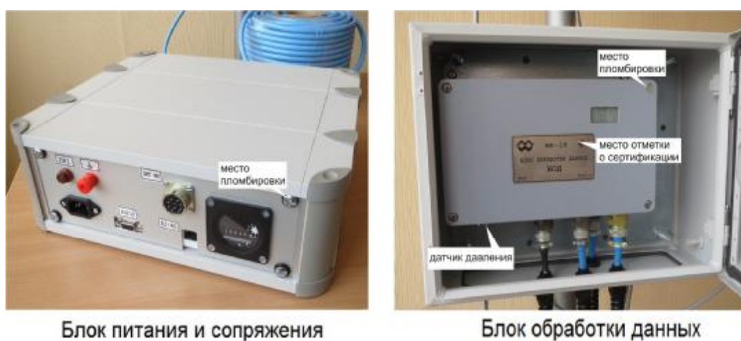
Рис. 2 Схема пломбирования комплексов МК-18
