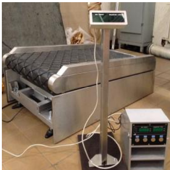
Рисунок 1 - Внешний вид весов конвейерных ленточных взвешивающих КЛВ
