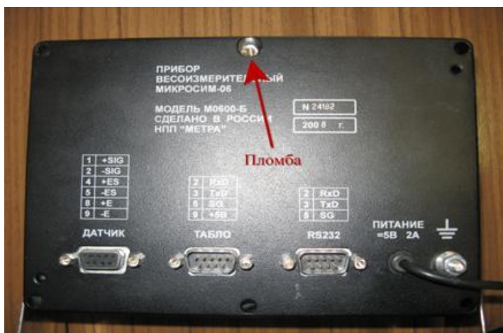
Рисунок 4 - Схема защиты от несанкционированного доступа в настройки и обозначение места для нанесения оттиска клейма.
