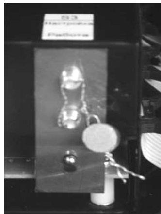
Рисунок 7 – Пломбировка фиксирующей планки блока индикации и управления «КВАНТ»
