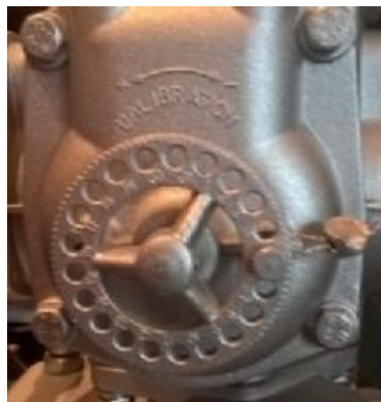
Рисунок 3 – Пломбировка счетчика жидкости объемного типа RSJ
