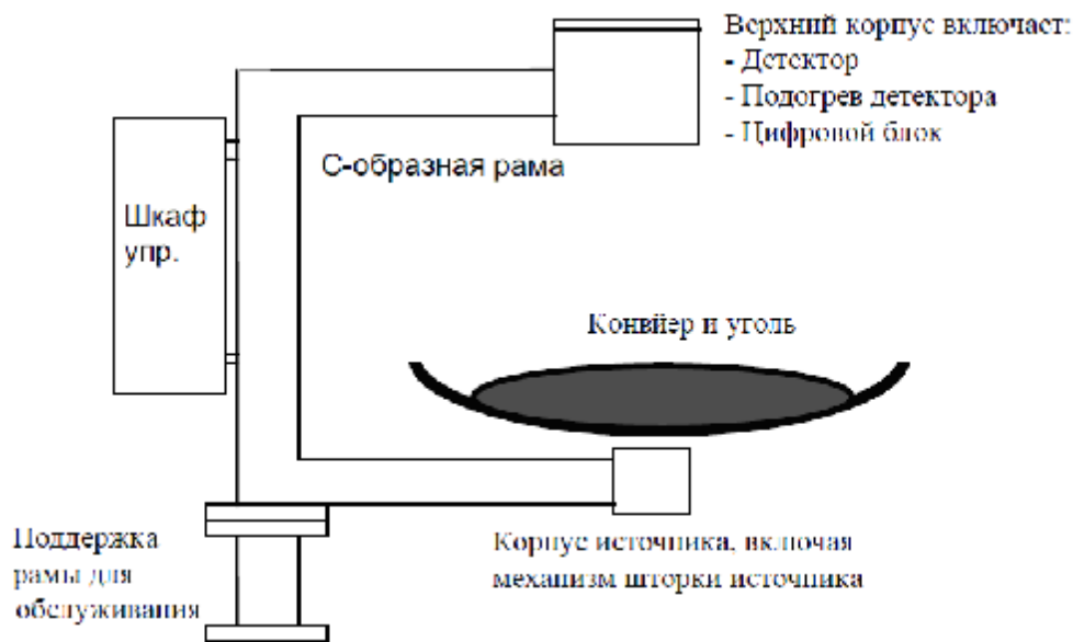
Рис. 2 Устройство анализаторов CoalScan
