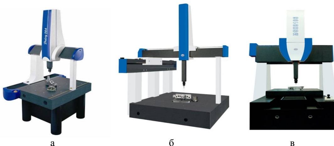
Рисунок 1 - Общий вид КИМ серий Daisy (а), ML (б), MGH (в)
