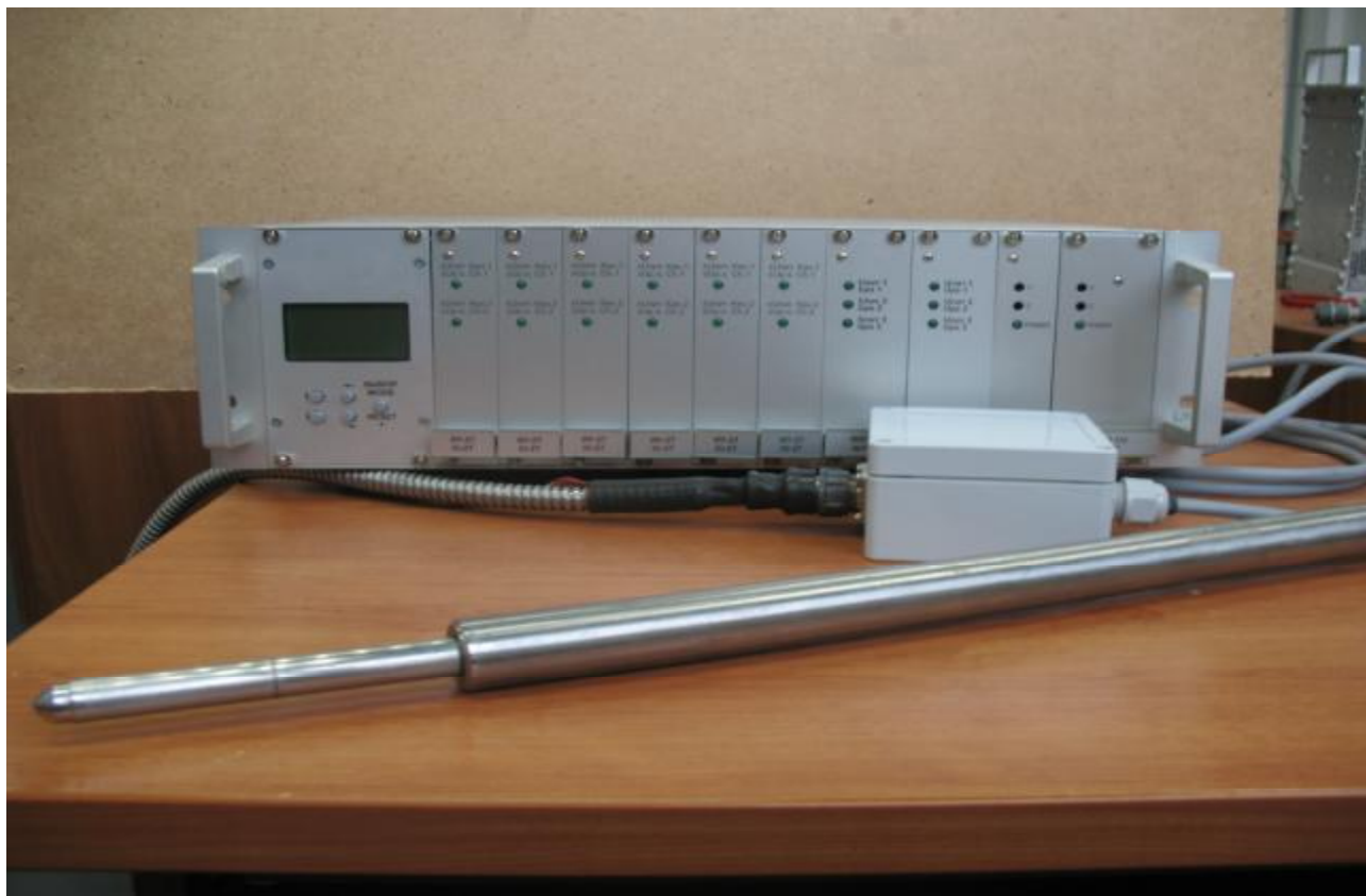
Рисунок 2. Общий вид каналов измерительных относительного перемещения ДКНБ.401163.001
