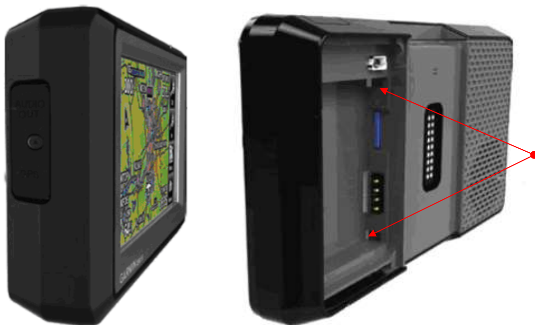
Рисунок 2 - Внешний вид отсека аппаратуры для установки аккумуляторной батареи под откидывающейся крышкой на задней части корпуса
