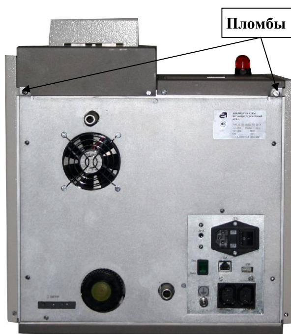
Рисунок 2. Задняя панель анализатора с указанием места пломбировки от несанкционированного доступа.
