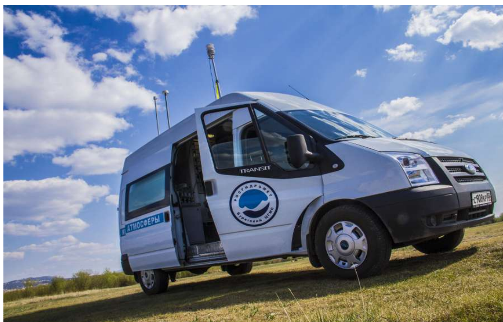
Рисунок 2 – Вид станции АСК-А-2.2. в передвижном исполнении на базе микроавтобуса.
