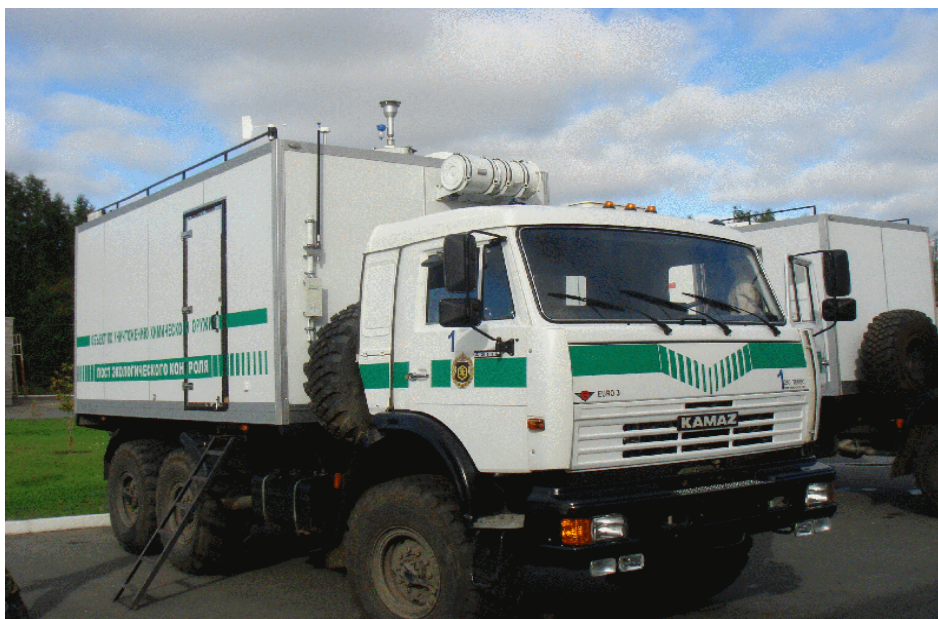
Рисунок 3 – Вид станции АСК-А-3.2. в передвижном исполнении на базе грузового автомобиля повышенной проходимости.
