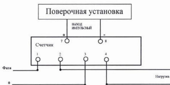
Рисунок 6 Схема подключения счётчиков ИНТЕГРА 101 к поверочной установке и к нагрузке
