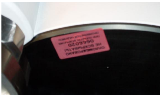
Рисунок 2 - Схема пломбировки от несанкционированного доступа
