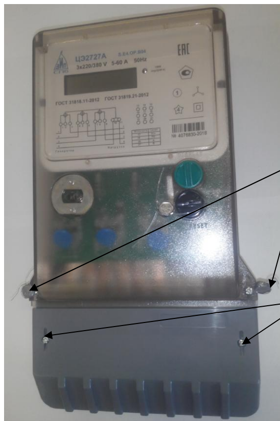
Рисунок 4 - Общий вид счетчика в корпусе В04 с кожухом под оптопорт и места пломбирования
