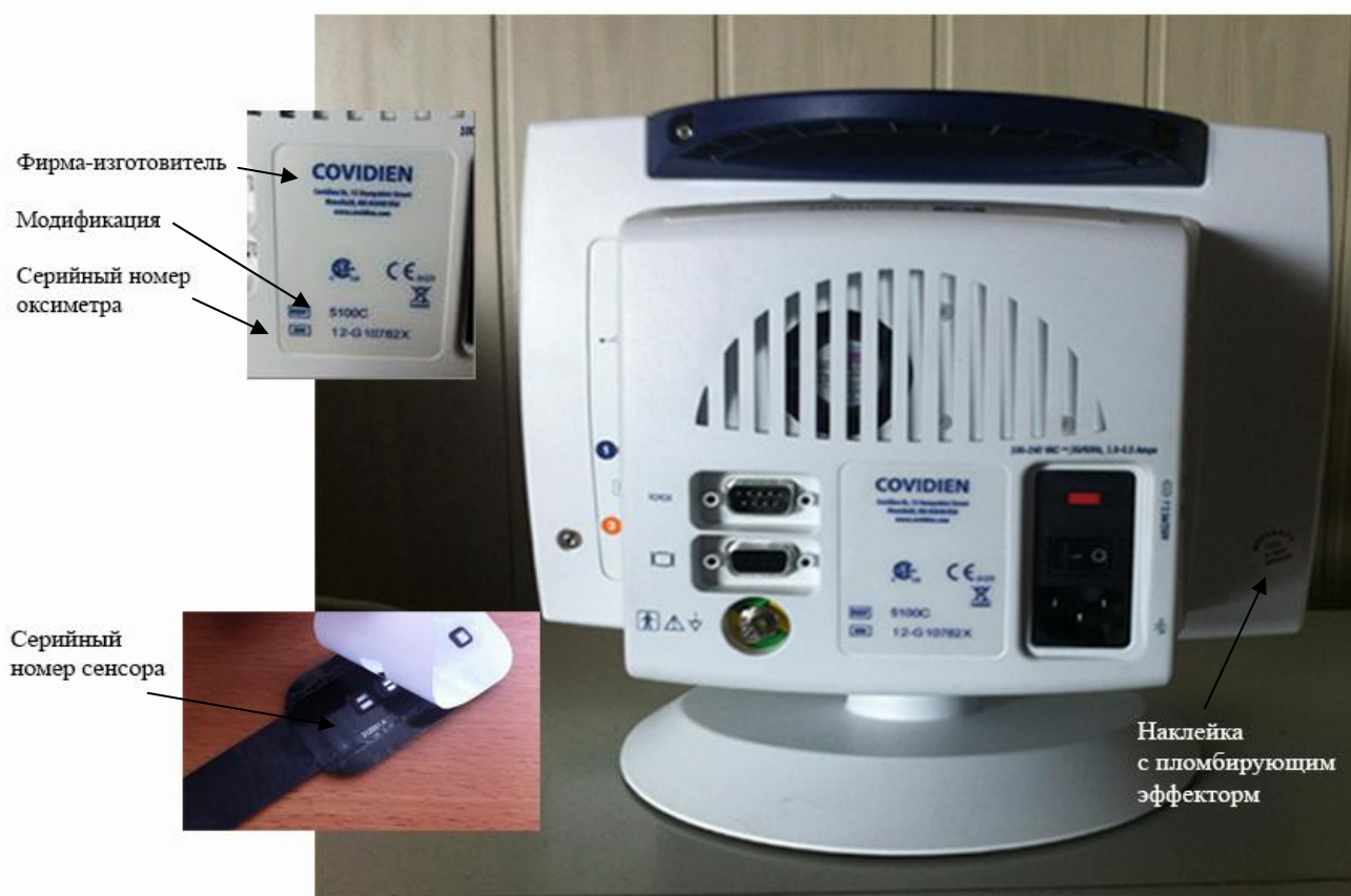
Рисунок 2 – Схема маркировки оксиметров церебральных/соматических Invos 5100C
