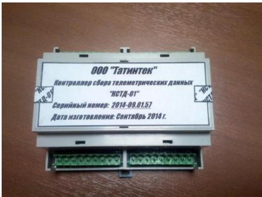
Рисунок 1 - Пломбировка корпуса контроллера «КСТД-01» (вид спереди)
