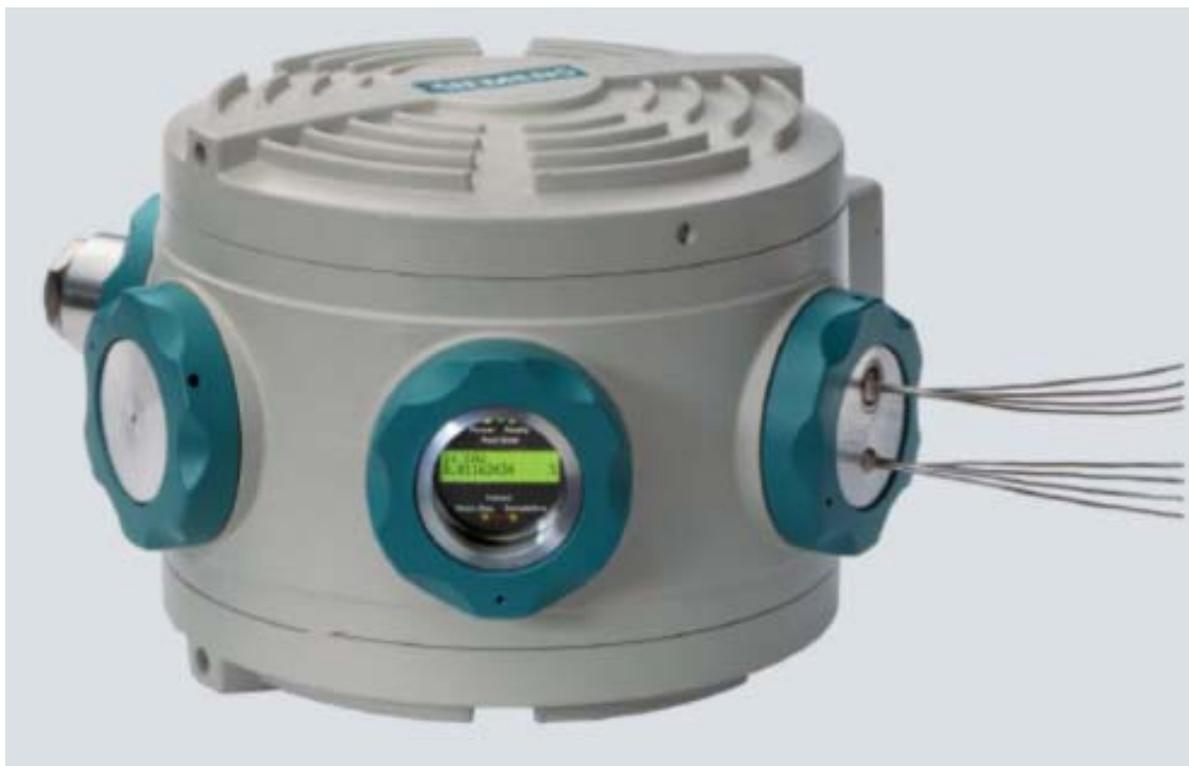
Рисунок 1 - Общий вид хроматографов газовых промышленных специализированных МикроСАМ РУС
